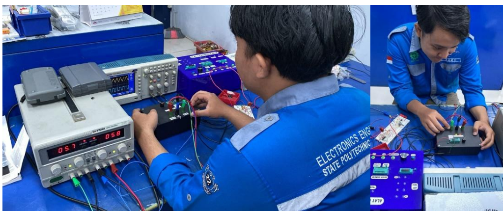
Gambar 8 Pengujian IC Op-Amp 741 Sebelum Praktikum
