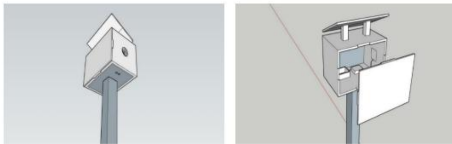
Gambar 3: Desain 3D alat monitoring bibit mangrove yang dipasang dipesisir pantai
