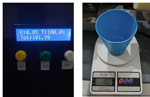
Gambar 3. Pengujian Load Cell
