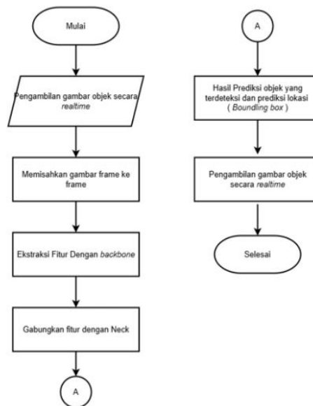
Gambar 1. Flowchart sistem kerja YOLO
