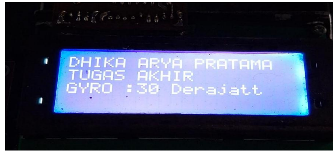
Gambar 9: Hasil Pembacaan Sensor pada Sudut 30°
