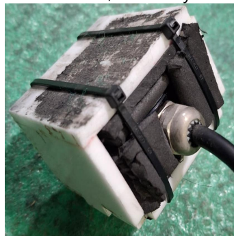
Gambar 3: Penggunaan Akrilik dan Foam untuk Meredam Elektromagnetik
