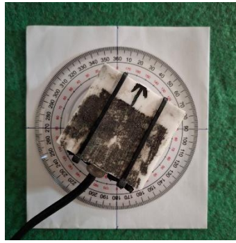
Gambar 8: Hasil Pengukuran Menggunakan Busur pada Sudut 30°
