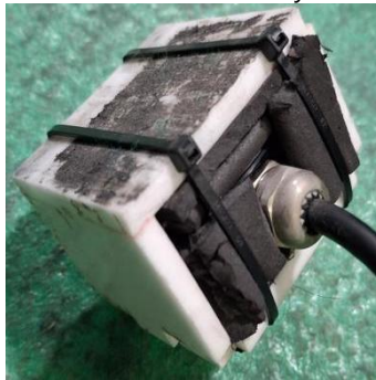
Gambar 3: Penggunaan Akrilik dan Foam untuk Meredam Elektromagnetik
