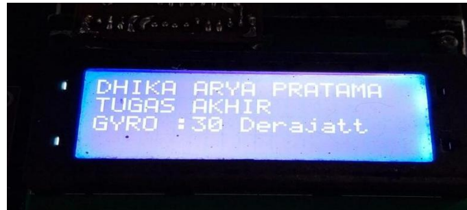
Gambar 9: Hasil Pembacaan Sensor pada Sudut 30°
