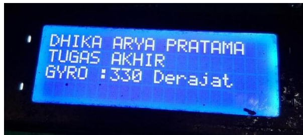
Gambar 5: Hasil Pembacaan Gyroscope pada Robot Sepak Bola Beroda
