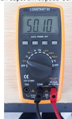
GAMBAR 3.4 FREKUENSI KELUARAN INVERTER
