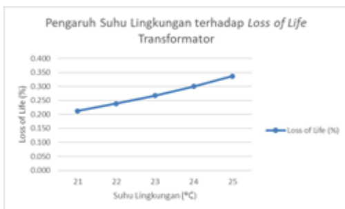
Gambar 4.3 Grafik Pengaruh Perubahan Suhu Lingkungan terhadap Susut Umur Transformator (Loss of life) pada Tahun 2018
