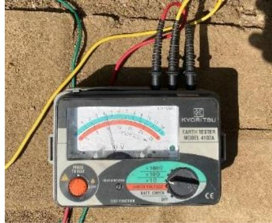
GAMBAR 3.7 PENGUKURAN TAHANAN PENTANAHAN DENGAN DUA ELEKTRODE PARALEL
