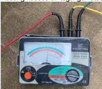
GAMBAR 3.6 PENGUKURAN TAHANAN PENTANAHAN DENGAN SEBUAH ELEKTRODE
