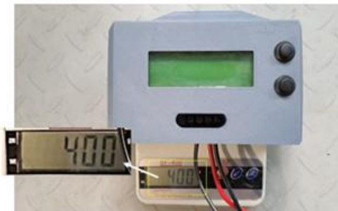
GAMBAR 2.3 HASIL PERENCANAAN CASING MPPT
