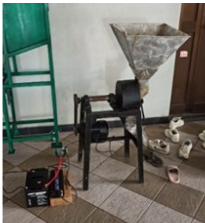
GAMBAR 3.7 PENGUJIAN INTEGRASI BATERAI DENGAN MESIN PENGGILING KEDELAI
