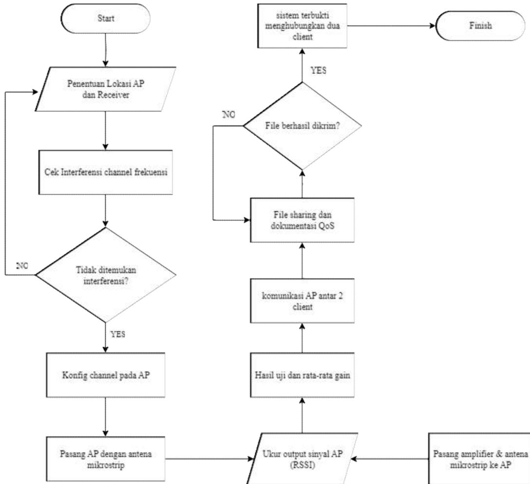
Gambar 3. Diagram alur proses pengujian
