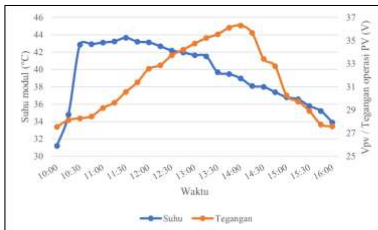
Gambar 5. Profil suhu modul dan tegangan operasi PV selama pengujian berbeban
