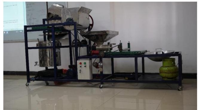
Gambar 2. Mesin Pembuat Dendeng Dari Jantung Pisang
