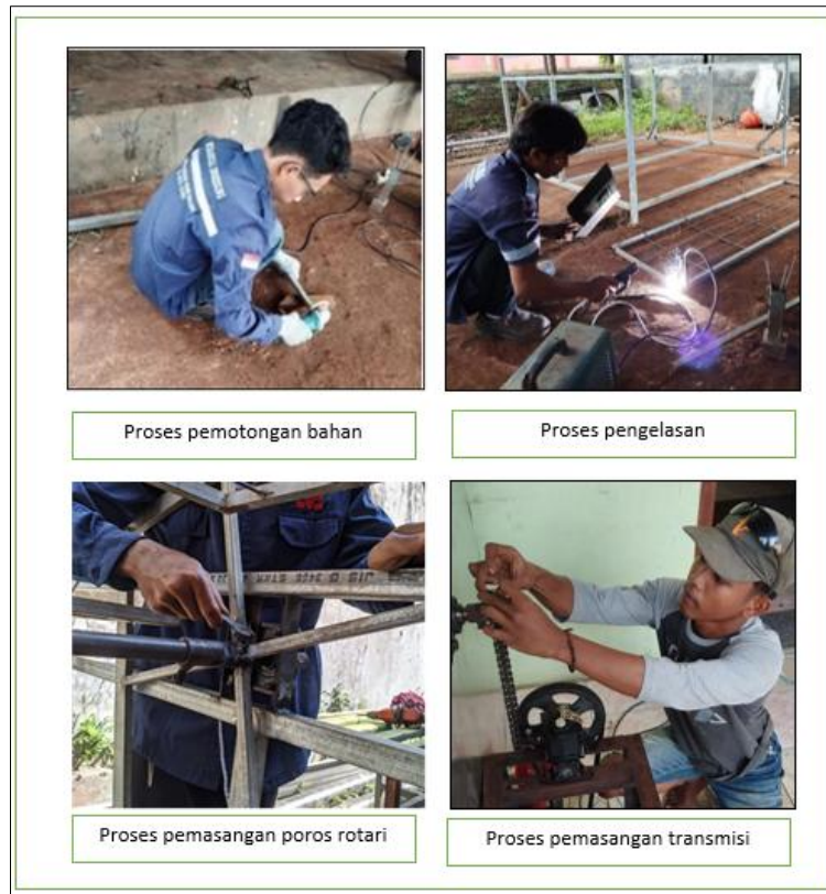
Gambar 6. Dokumentasi Proses Pembuatan dan Perakitan Mesin
