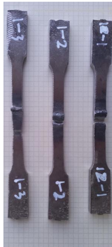
Gambar 2. Bentuk Patahan Hasil Pengujian Tarik SS 304 untuk tiga specimen pada 85 A SMAW
