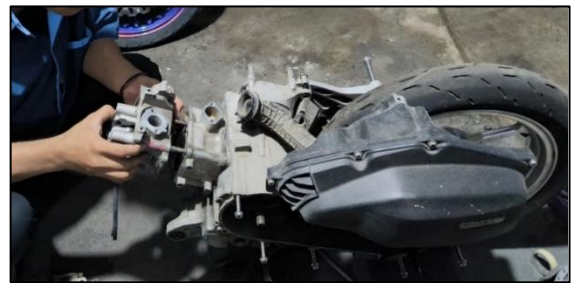
Gambar 8. Pemasangan Head Mesin pada Motor
