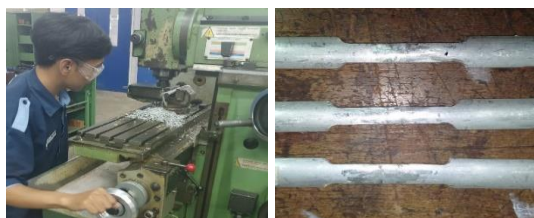
Gambar 7. (a) Proses pembuatan spesimen uji tarik dan (b) spesimen uji tarik
