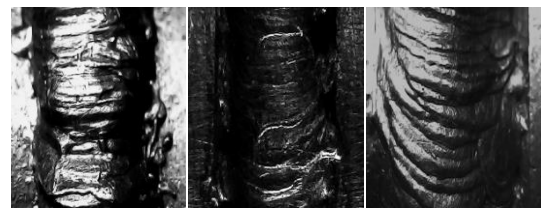
Gambar 4. Kecepatan Pengelasan 5 mm/detik dengan aliran gas pelindung, (a) 10 l/menit, (b) 12 l/menit, (c) 16 l/menit
