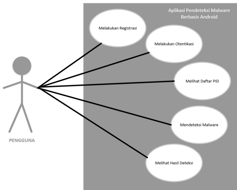
Gambar 5. Diagram Use Case Aplikasi Pendeteksi Malware Berbasis Android
