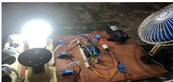
Gambar 20. Implementasi Prototye alat monitoring perkembangan jamur
