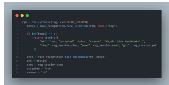
Gambar 11. Kode Proses Deteksi dan Ekstraksi Fitur Wajah
