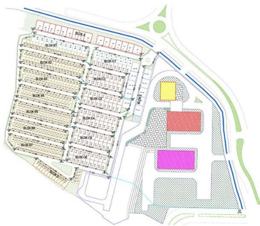
Gambar 2. Jaringan Drainase (Sumber : Perhitungan, 2025)
