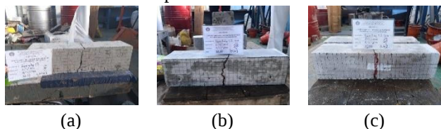
Gambar 2. Perbandingan pola retak balok (a) beton normal, (b) beton serat 5%-3 cm, dan (c) beton serat 5%-5 cm
