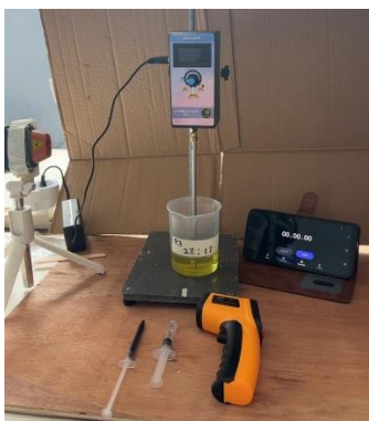
Gambar 2 Pengujian Pot Life
