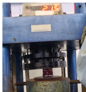
Gambar 3 Pengujian Kuat Tekan
