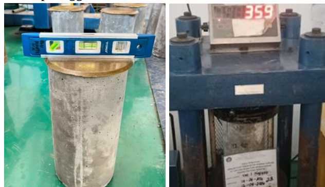
Gambar 4 Pengujian kuat tekan beton Sumber: Dok. Pengujian Laboratorium
