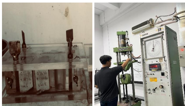
Gambar 3 Pengujian pasta silinder menggunakan UTM Sumber: Dok. Pengujian Laboratorium
