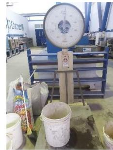
**Gambar 1** Proses Penimbangan Material untuk Melakukan Pengecoran
