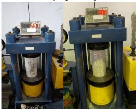
Gambar 3 Pengujian Kuat Tekan Beton
