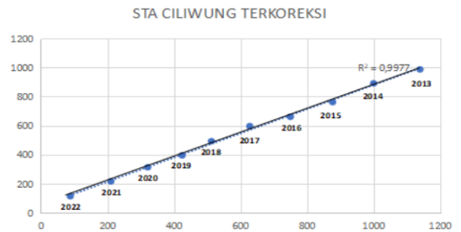
Gambar 1. Grafik Analisis Kurva Massa Ganda Sta. Ciliwung terhadap Sta. Jabung dan Sta. Sukun Terkonsistensi Sumber: Hasil Analisis
