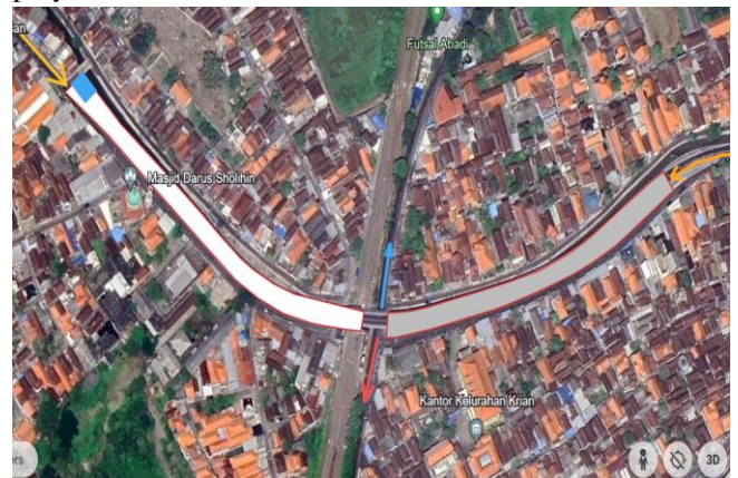
Gambar 5. Traffic Management Proyek Pembangunan Fly Over Pengganti JPL 64 KM 38+897 Lintas Surabaya-Solo
