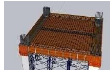
Gambar 15. Pemasangan pembesian plat lantai
