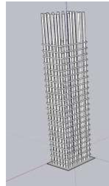
Gambar 5. Pemasangan tulangan pada kolom
