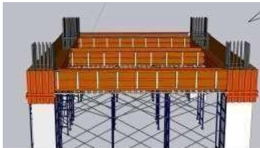
Gambar 11. Pemasangan tembereng balok
