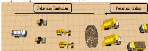
Gambar 11 Ilustrasi pekerjaan galian dan timbunan
