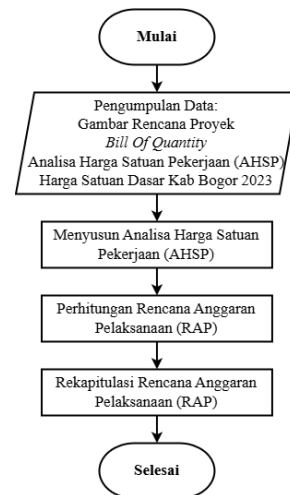
Gambar 10. Flow chart Penyusunan RAP Proyek Pembangunan Gedung Mall dan Hotel X
