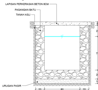
Gambar 4. Potongan Melintang Saluran Baru F4-F3
