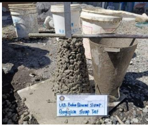
Gambar 1. Sampel hasil Pengujian Slump
