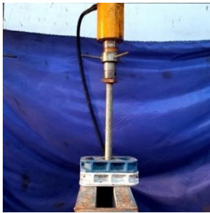
Gambar 3. Kompresi Benda Uji
