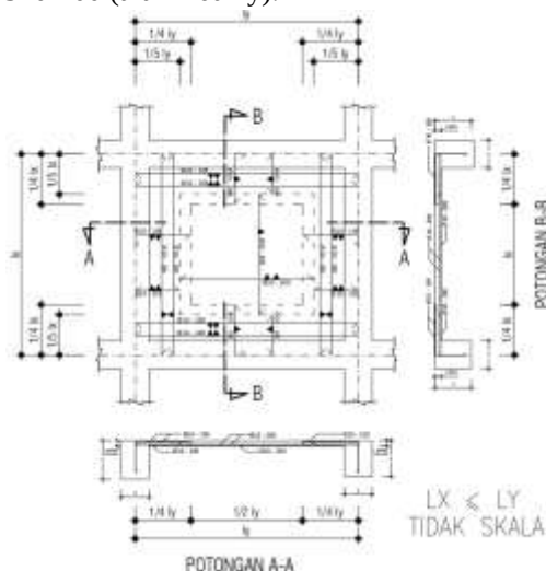
Gambar 3.11 Detail penulangan pelat lantai Sumber: Dokumen Pribadi
