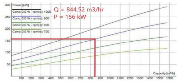
Gambar 4. Hasil Penentuan Daya 1 Pompa Untuk Konfigurasi 5 Pompa
