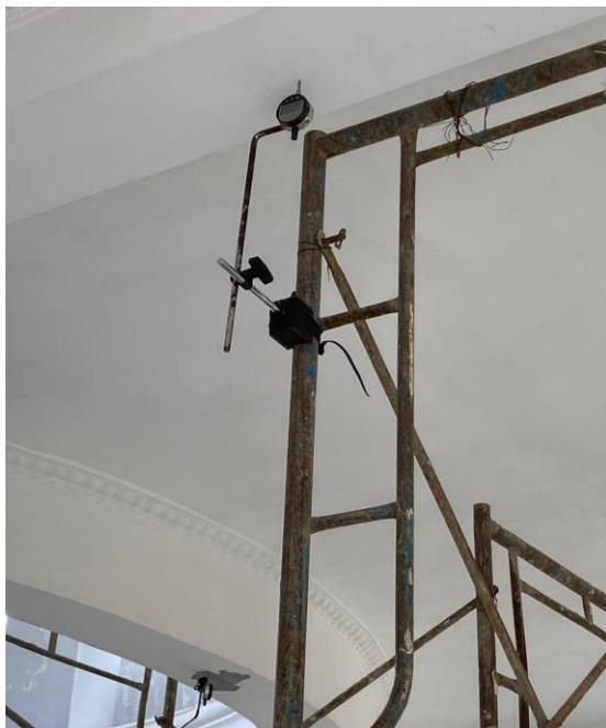
Gambar 7 Penempatan Dial Gauge Pengukur Lendutan
