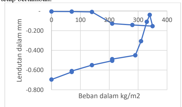
Gambar 9 Hubungan Beban dan Lendutan pada D2 (Pelat)
