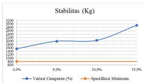
Gambar 6. Hubungan Campuran Substitusi Limbah Masker dan Limbah AMP sebagai Filler dengan Stabilitas
