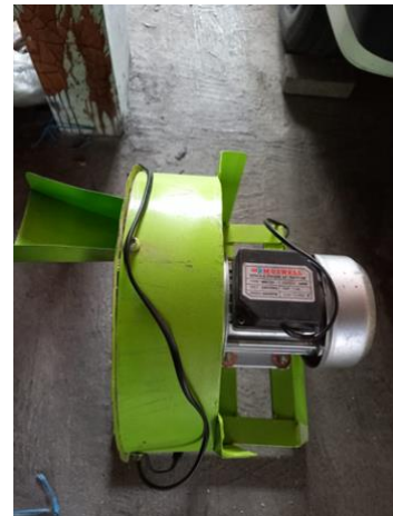
Gambar 5. Motor Induksi yang sudah terpasang pada mesin giling kopi
