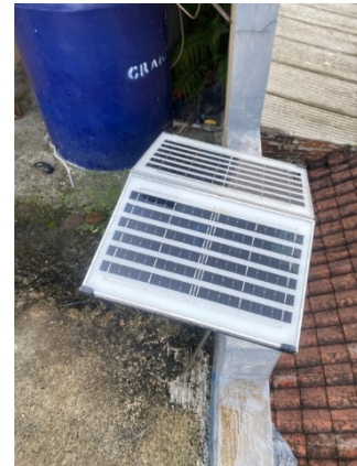
Gambar 11. Uji Ketahanan Terhadap Hujan
