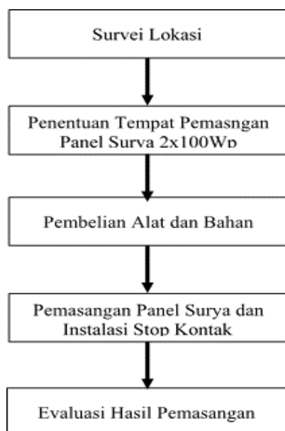
Gambar 2. Flowchart pemasangan panel surya
