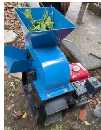
Gambar 2. Mesin pencacah pakan serbaguna
