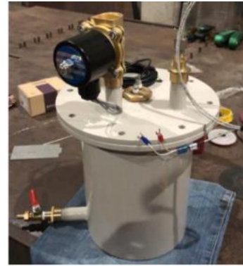
Gambar 4. Sel Uji Penuaan Termal Dipercepat Sistem Isolasi Transformator
