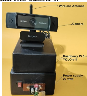
Gambar 6 Perangkat IoT untuk pendeteksi plat nomor kendaraan bus
