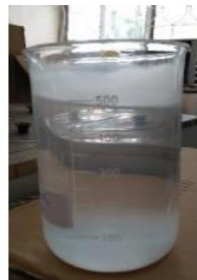
**Gambar 3.** Endapan CaCO<sub>3</sub> yang terbentuk
